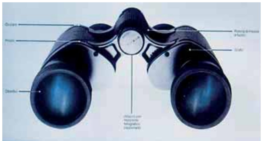
Il binocolo si può definire un doppio cannocchiale che raddrizza le immagini con prismi e che spesso contiene un attacco per poterlo fissare a un treppiede fotografico. (Cortesia ditta Auriga).
